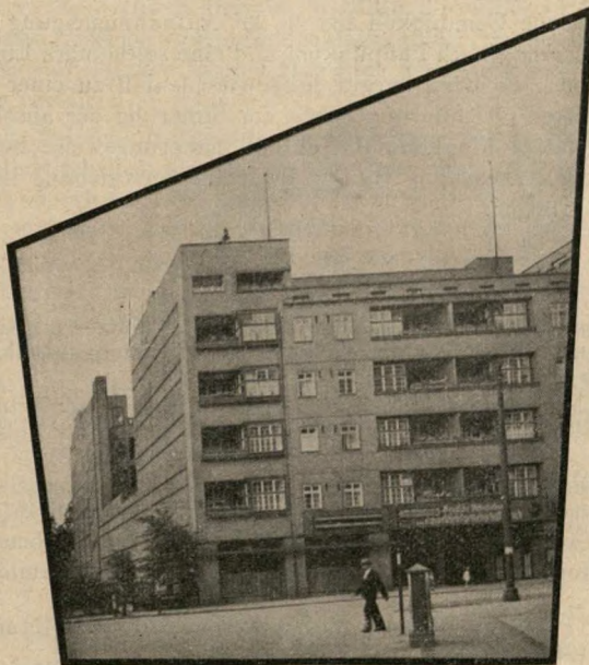
Abb. 7. Schrägaufnahme (links oben) einer schräg zum Beschauer gerichteten Gebäudefläche (entsprechend einer Schrägaufnahme geneigten Geländes). Die Entzerrung nach b) (rechts oben) mit a' z, v_b und v ergibt eine echte Horizontalaufnahme (entsprechend einer Nadiraufnahme geneigten Geländes). Die Forderung der Vertikalität ist erfüllt. Die Entzerrung nach a) (unten) auf richtigen Aufriß (Grundriß) kann nur mit Hilfe aller Freiheitsgrade einschließlich q durchgeführt werden.
