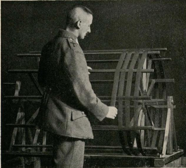
Abb. 20. Trockentrommel für d. Reihenbildnerfilme.
