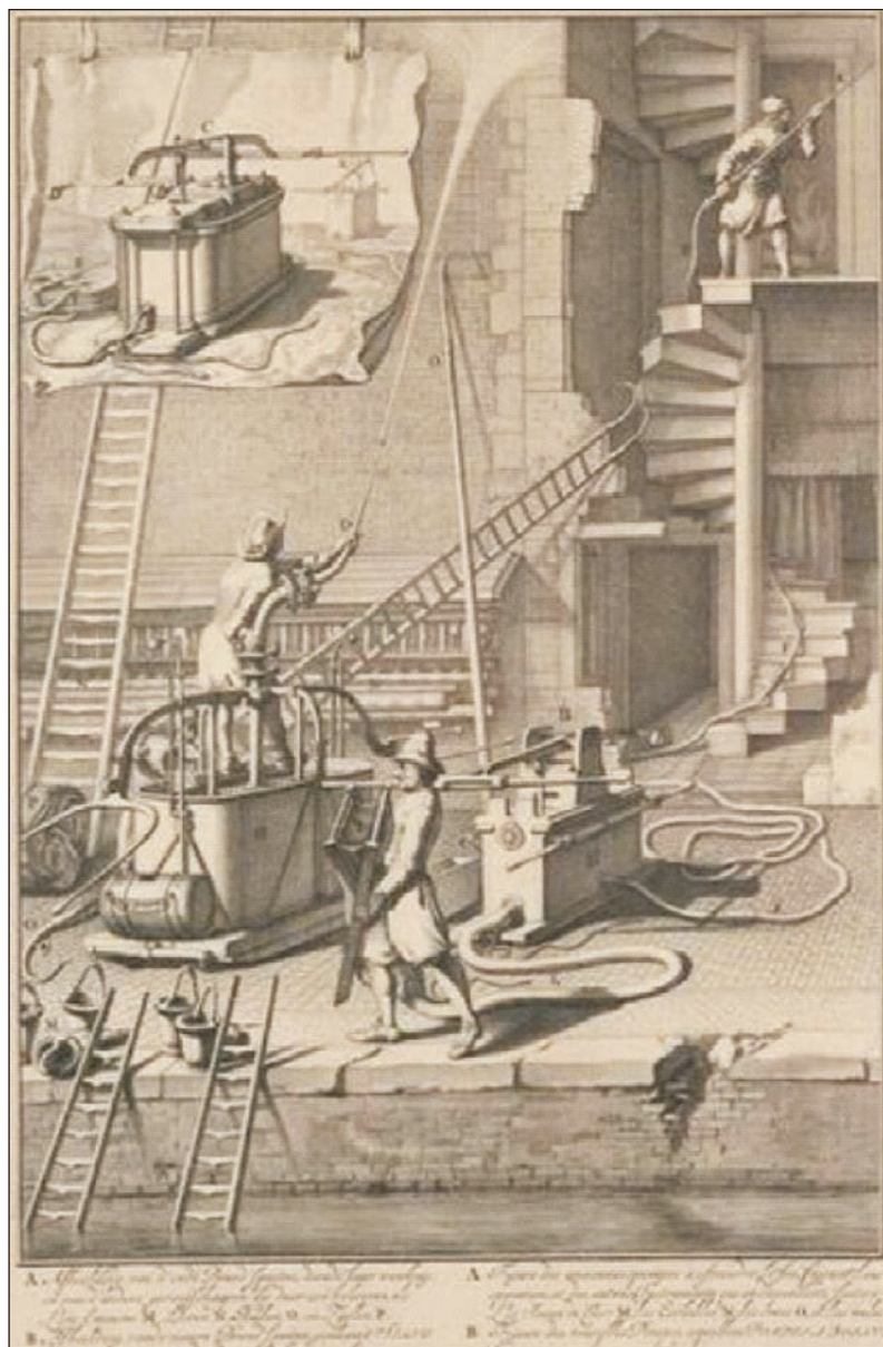
Ryc. 8. Konstrukcje sikawek ogniowych Jana van der Heyden, www.rijksmuseum.nl
