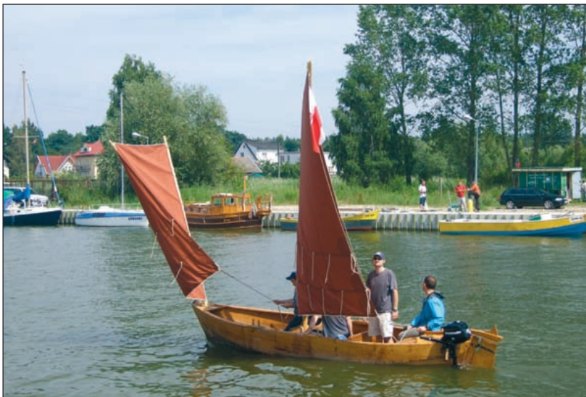
Ryc. 5. Zrekonstruowana w Muzeum Zalewu Wiślanego w Kątach Rybackich łódź typu „żakówka”. Rekonstrukcję wzorowano na oryginalnej łodzi „Kąt 99”. Fot. T. Simlat
