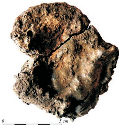
Ryc. 2. Kruszwica, stan. 2. Przykład żużla miseczkowego grupy I, koniec XII w. Fot. T. Sawicki
