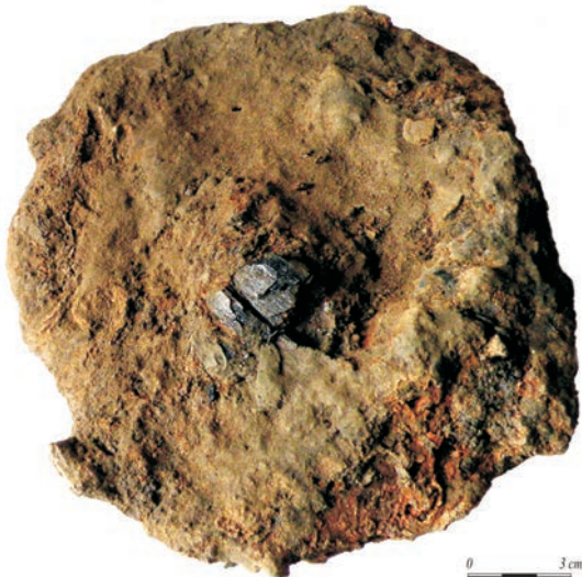
Ryc. 1. Kruszwica, stan. 2. Przykład żużla miseczkowego grupy I, początek XII w. Fot. T. Sawicki
