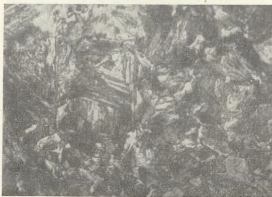
Ryc. 3. Łazy, pow. Kielce. Nóż nr 1: a — makrostruktura na przekroju poprzecznym. Części nawęglone uległy zaciemnieniu, traw. azotalem, pow. 8 x; b — struktura nienawęglonej części noża: ferryt, traw. azotalem, pow. 100 x; c — struktura nawęglonej części noża: troostyt iglasty, traw. azotalem, pow. 500 x
