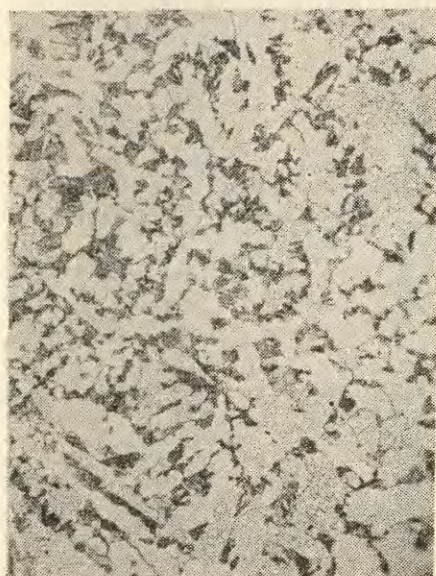
Ryc. 3. Kryspinów, woj. Kraków. Struktury metalograficzne przedmiotów: a – struktura umba, traw. azotalem, pow. 100 ×; b – struktura wtrąceń umba, nietraw.; c – struktura nitu umba, traw. azotalem, pow. 100 ×; d – struktura nitu umba pod większym powiększeniem, traw. azotalem, pow. 500 ×
