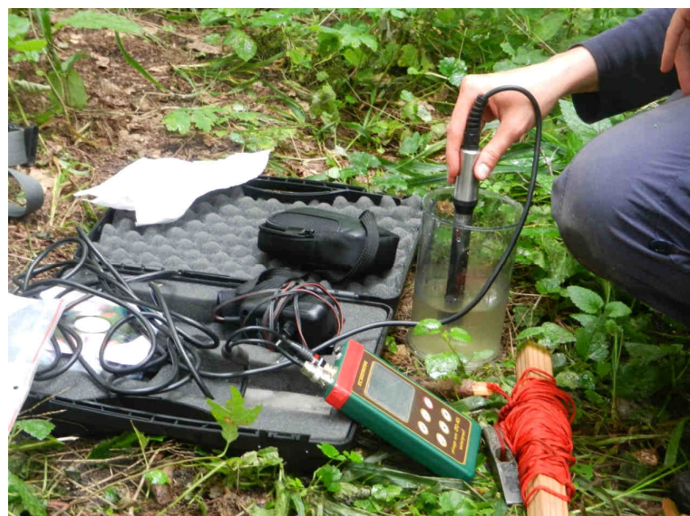
Ryc. 11. Pomiar stężenia tlenu zawartego w wodzie przy użyciu czujnika Elmetron COG-2 (fot. J. Wolski)
