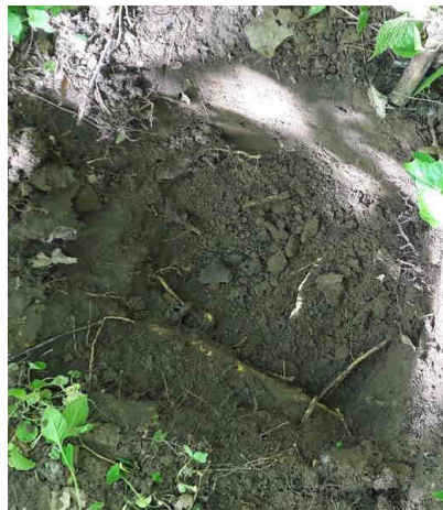
Ryc. 29. Próba badawcza o wymiarach 25×25 cm i 30 cm w głąb profilu glebowego (fot. E. Regulska)
