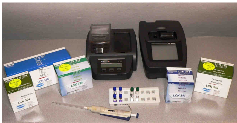
Ryc. 13. Spektrofotometr Hach Lange DR2800 z mineralizatorem oraz testami kuwetowymi (fot. M. Kaszubski)
