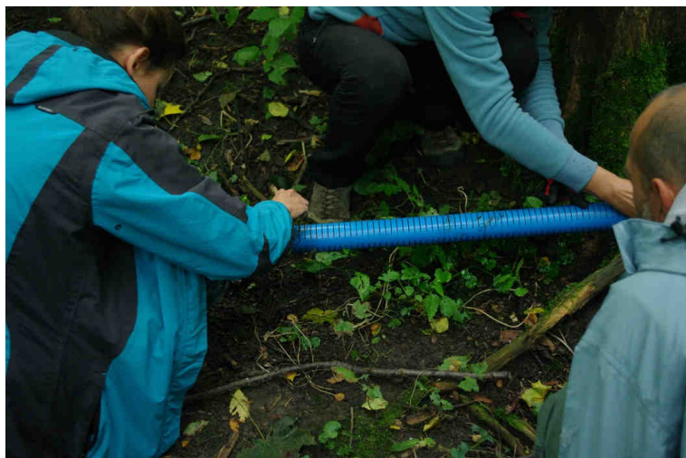
Ryc. 8. Przygotowanie rury studziennej do montażu na powierzchni badawczej (fot. E. Kończowska)
