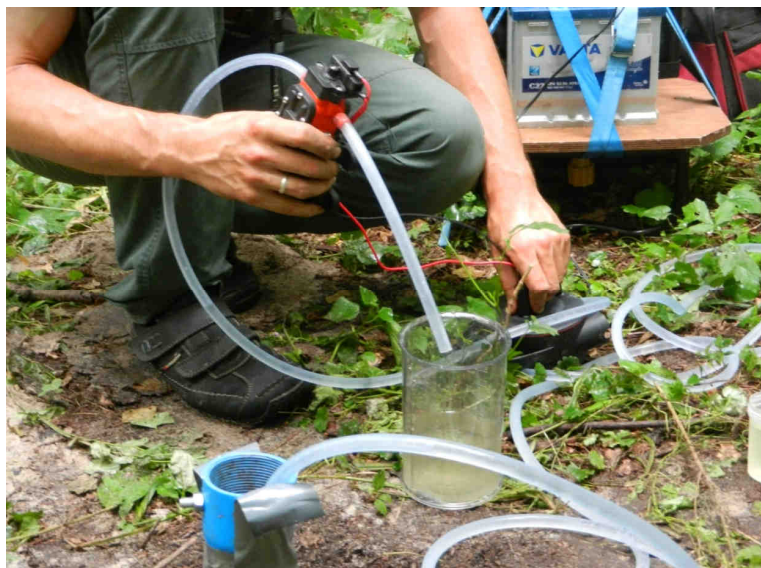
Ryc. 10. Pobór wody do analiz chemicznych za pomocą pompy ciśnieniowej (fot. A. Kowalska)
