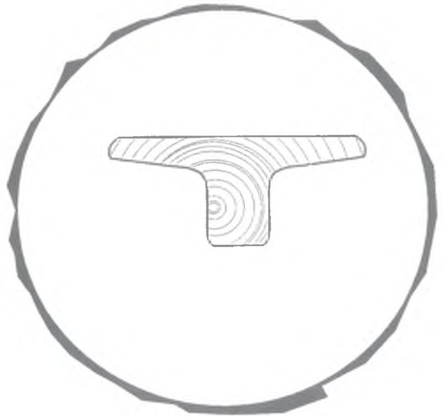
Ryc. 4. Umiejscowienie stępki względem pnia w łodzi z Łądu Fig. 4. Cross section of keel from Łąd wreck fitted into parent log
