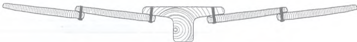
Ryc. 7. Orientacja przyrostów rocznych w klepkach poszycia łodzi z Łądu Fig. 7. Orientation of the tree rings in bottom planks from Ląd-wreck
