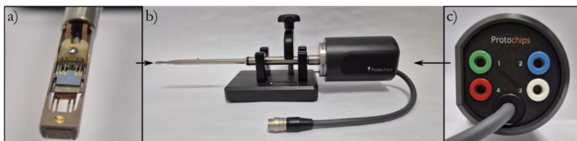
Rys. 6.4 Uchwyt Protochips Fusion do badań elektrycznych TEM: a) widok części uchwytu z próbką na chipie zamontowanym w urządzeniu; b) widok z boku uchwytu z widocznym kablem sterującym nachyleniem preparatu ( \beta ) w mikroskopie; c) koniec uchwytu będący na zewnątrz kolumny TEM w trakcie badań, do którego podłączane jest sterowanie elektryczne chipem.
