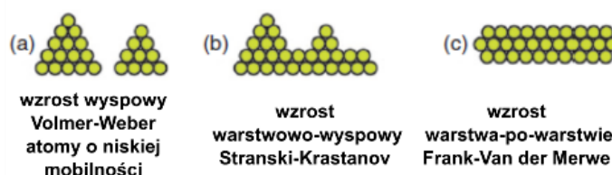
Rysunek 9 Schematyczny obraz podstawowych modeli wzrostu warstw epitaksjalnych. Ilustracja na podstawie rysunku z [123]
