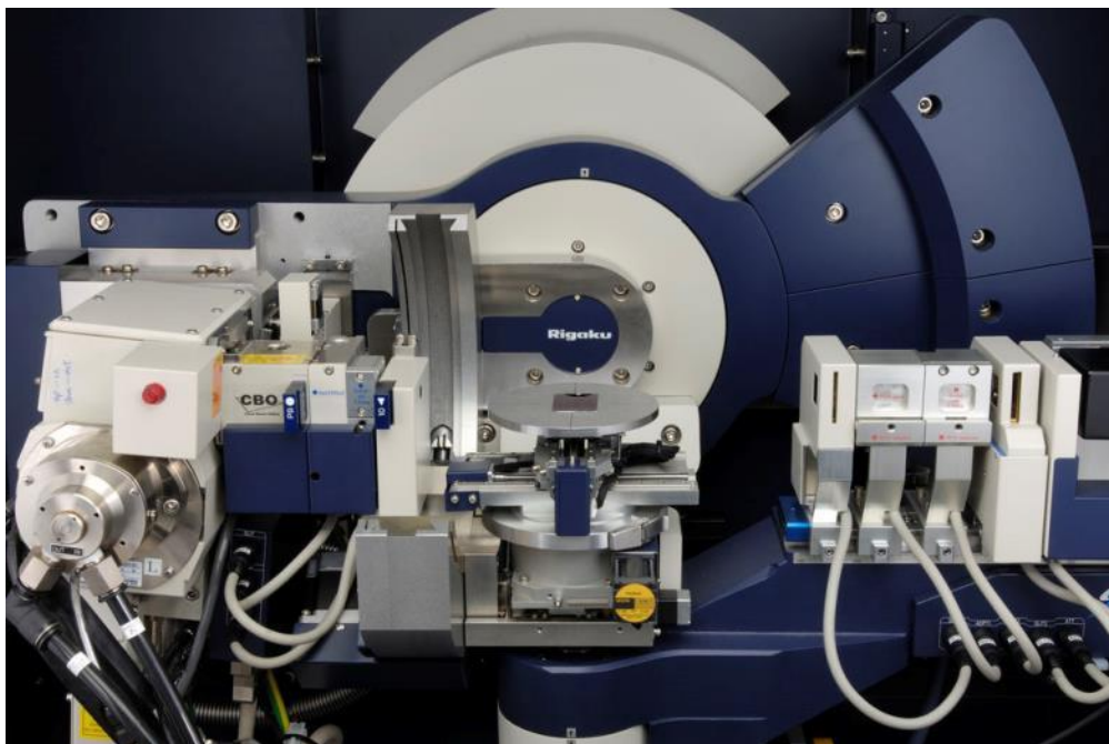
Rys. 2.1. Wnętrze dyfraktometru rentgenowskiego Rigaku SmartLab 3kW (rysunek pochodzi ze strony internetowej firmy Rigaku [ http://www.rigaku.com/ ]).
