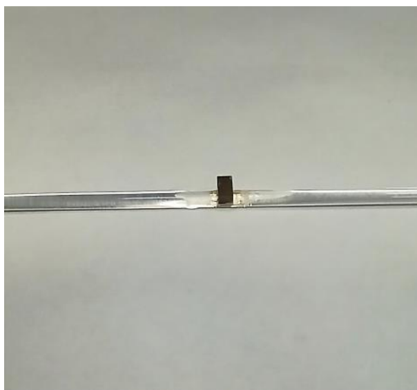
Rys. 2.3. Próbką monokryształu Fe_{7-x}A_xSe_8 ( A = Ni ) przyklejona do pręta kwarcowego.
