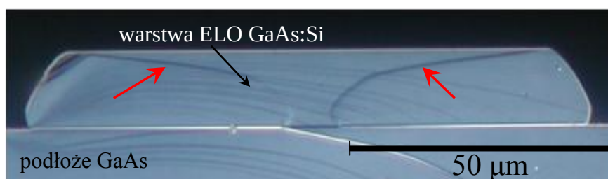
Rys. 4.12. Przykładowy obraz przełomu pojedynczego paska ELO GaAs:Si wykonany przy pomocy mikroskopu optycznego z różnicowym kontrastem Nomarskiego. Strzałkami zaznaczono linie oddzielające obszary o różnej zawartości domieszki Si.
