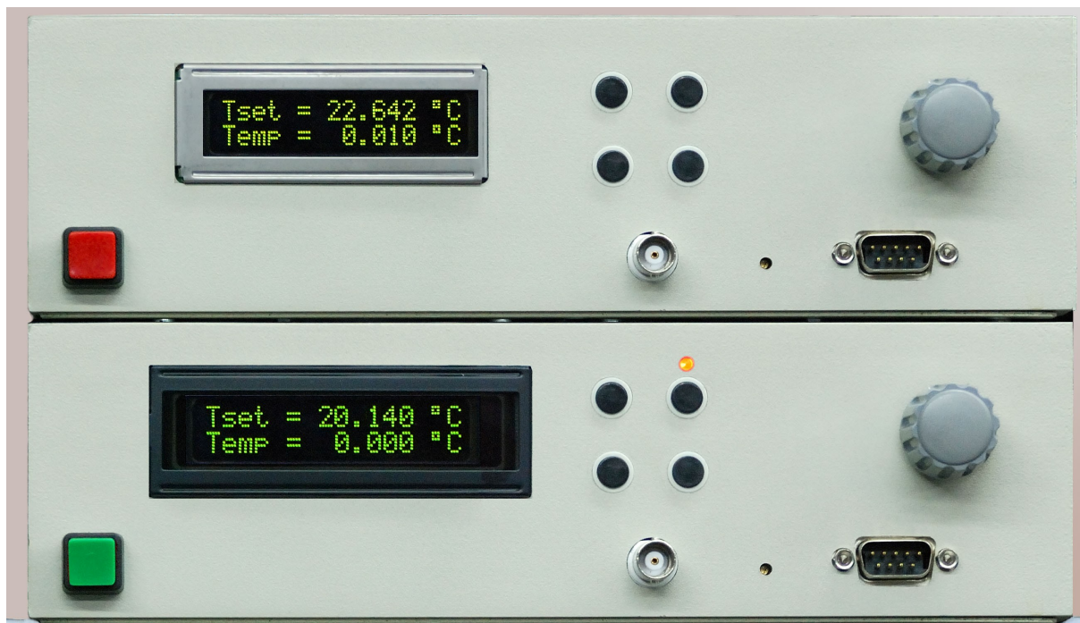
Rys. 6.3 Precyzyjny stabilizator temperatury.
