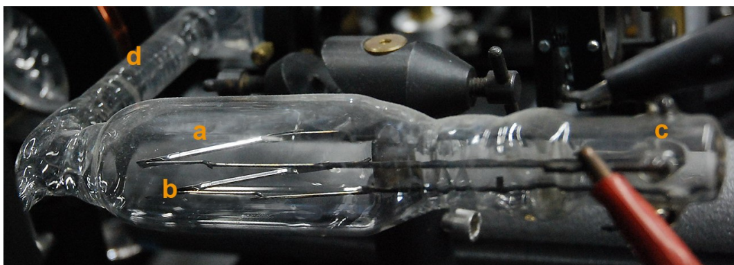
Rys. 2.17 Sposób umieszczenia dyspenserów rubinowych zasilających komórkę MOT parami rubidu. a, b – dyspensery. c – próżniowe przepusty zasilające; d – połączenie z komórką (przejście pyrex – kwarc) .
