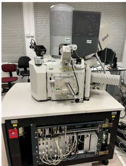
Rysunek 9. Zdjęcie skanującego mikroskopu elektronowego FEI Nova NanoSEM 450.
