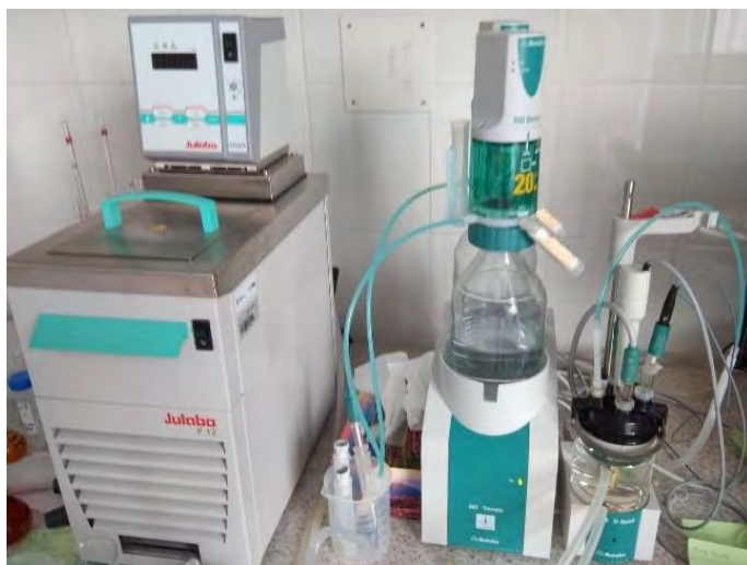
Rysunek 12. Układ pomiarowy do badania stężenia jonów \text{Ca}^{2+} oraz pH.
