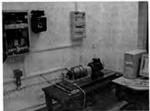
Rys. 2. Stanowisko do badania uszkodzeń silników asynchronicznych
