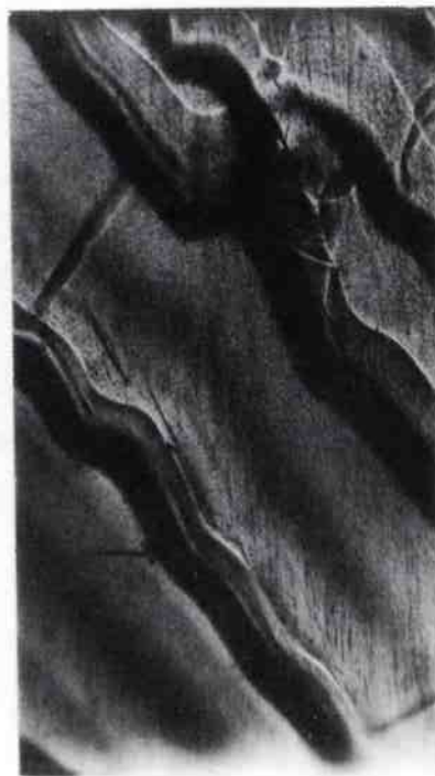
Rys. 22. Obraz wytrąceń domieszki na powierzchni czotowej monokrysztatu w obszarze pokazanym na rys. 21 /pow. 80x/
