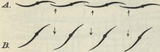
Рис. 156. Схема положенія маховыхъ перьевъ—въ поперечномъ разрѣзѣ—и дѣйствія сопротивленія воздуха, направленіе котораго указано стрѣлками,—при опусканіи (А) и подниманіи (В) крыла.
