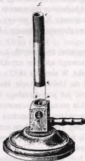
Ryc. 1. Wizerunek palnika bunsenowskiego zamieszczony we wspólnym artykule Bunsena i Roscoe'a z 1857 r.
