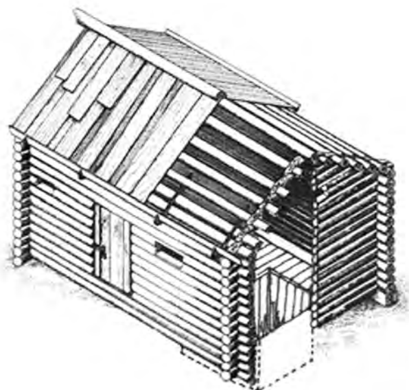
Ryc. 6-10. Rekonstrukcja wczesnośredniowiecznego budynku zrębowego z piwniczką w narożniku. Wg Gołembnik 2000.
