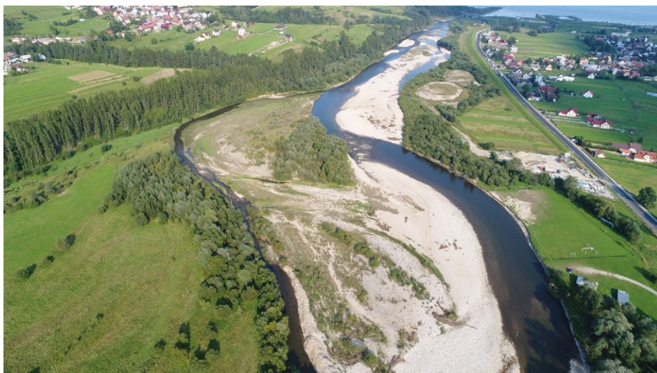
Fot. 1. Wymuszona depozycja osadów korytowych Dunajca w cofce funkcjonującego od 1997 r. Zbiornika Czorsztyńskiego przyczyniła się do wzrostu szerokości koryta w tej strefie (fot. M. Liro) Forced in-channel sediment deposition of the Dunajec within the backwater zone of the Czorszтын Reservoir (built in 1997) favours local channel-widening
