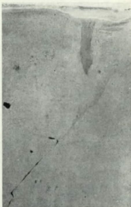
Fot. 4. Doświadczenie modelowe, na przedłużeniu szczeliny powstał klin pierwotny — duży, a w nim inicjalny klin wtórny — mały. Wyrzucane na powierzchnię cząstki ziemiste budują warstewki poziome (niewielkie powiększenie).
