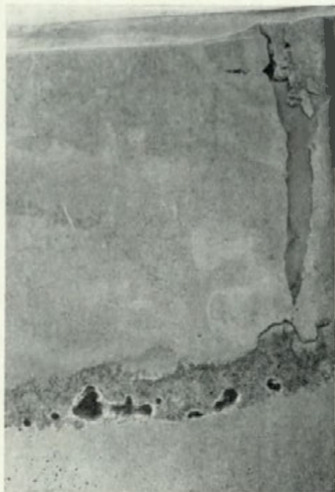
Fot. 3. Doświadczenie modelowe, wstępujący ruch gazu sortuje masę ziemistą gromadząc ziarna piasku na dnie przewodu, daje to zaczątek klina piaskowego, frakcje drobnoziarniste są wyrzucane na powierzchnię (wielkość naturalna).
