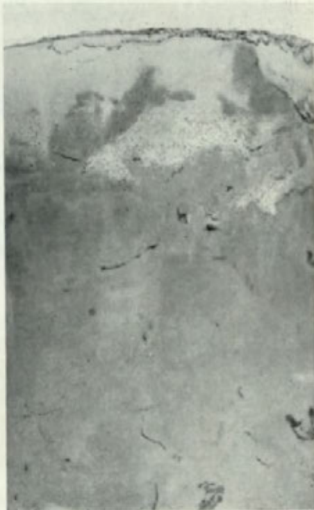
Fot. 10. Doświadczenie z wpływem gazów fermentacji beztlenowej na deformację utworu warstwowanego, etap trzeci — glina umieszczona poniżej warstw piasku i pyłu została wyciśnięta do samej powierzchni (wielkość 1,5 raza zmniejszona).
